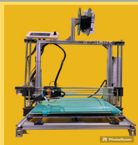
1-р зураг. 3D принтер угсрагдаж дууссан байдал
