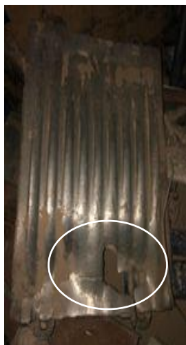
1-р зураг. Салхитын мөнгөний орд дахь анхан шатны (500x850) хацарт бутлуурын дээд ба доод талаар нь сольж тавьсан хөдөлгөөнгүй бутлах хавтангийн элэгдсэн байдал (01.22)
