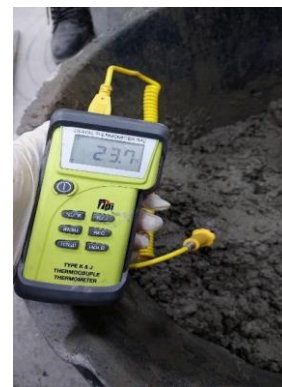
3-р зураг. Туршилтын зуурмагийн конусан суулт, температурыг шалгаж байгаа байдал
