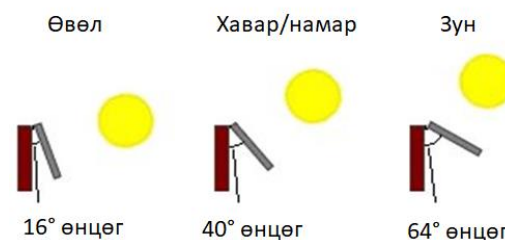
Зураг 3. Нарны эрчим хүчний нөөц, хавтанг 4 улирлаас хамаарч байрлуулах өнцөг
