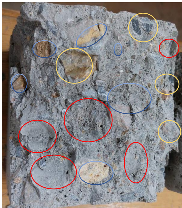
8-р зураг. Бетоны бат бөх, карбонатлаг эрдэс идэвхт нэмэлтийн хамаарал (хагарсан шар дүүргэгч-хөх цалгираг, мултарсан дүүргэгчийн сугарсан талбайг улаан цагаригаар, эвдрээгүй сугарч үлдсэн дүүргэгчийг шар цагаригаар дүрслэв).
