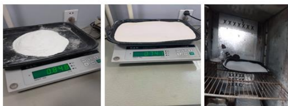
2-р зураг. Барилгын гөлтгөнийг лабораторид гарган авсан байдал
