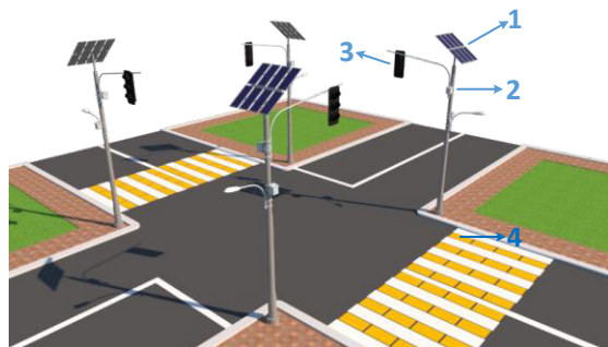
Зураг 7. Дөрвөн замын уулзварыг сэргээгдэх эрчим хүчээр хангах загварчлал. 1. Нарны хавтан 2. Wifi удирдлага 3. Гэрлэн дохио 4. Пьезо хавтан
