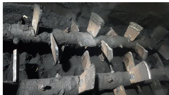
4-р зураг. Бөхжүүлсэн хутгыг төхөөрөмжид суурилуулсан байдал
