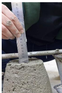
3-р зураг. Туршилтын зуурмагийн конусан суулт, температурыг шалгаж байгаа байдал
