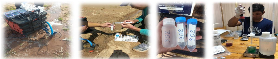
Зураг 3. а Хээрийн параметр (ДКК-ТОА багажнууд) хэмжиж буй байдал, б Гидрогеохимийн сорьцлолт, в Сорьцны сав, г Хээрийн нөхцөлд гидрокарбонат хэмжиж буй байдал
