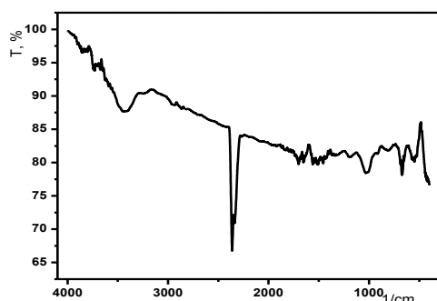
Зураг 3. Цэвэршүүлсэн бал чулууны баяжмалын нэл улаан туяаны спектр
