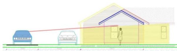
8-р зураг. Машины дууг тусгаарлаж болох 2м өндөр хашааны дуу тусгаарлалтын шугамын дүрслэл 1 давхар байшингийн хувьд
