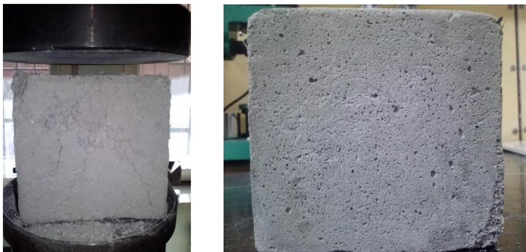
Зураг 3. Хөөсөн бетоны шахалтын бат бөхийг шалгасан байдал ба сүвэрхэгжилт
