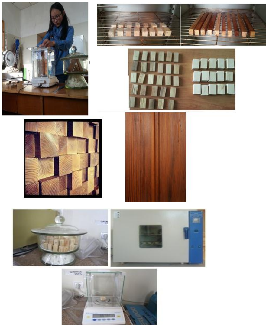
Зураг 2. Хэмжигч, луп, сорьц, шугам, хурц хутга, электрон жин, эксикатор
