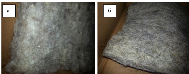
Зураг 5. Чийглэг орчинд хадгалсан шинэ нэр төрлийн бүтээгдэхүүн (а) ба энгийн эсгий (б)-ний цагаан эрвээхийд тэсвэрлэх байдал
