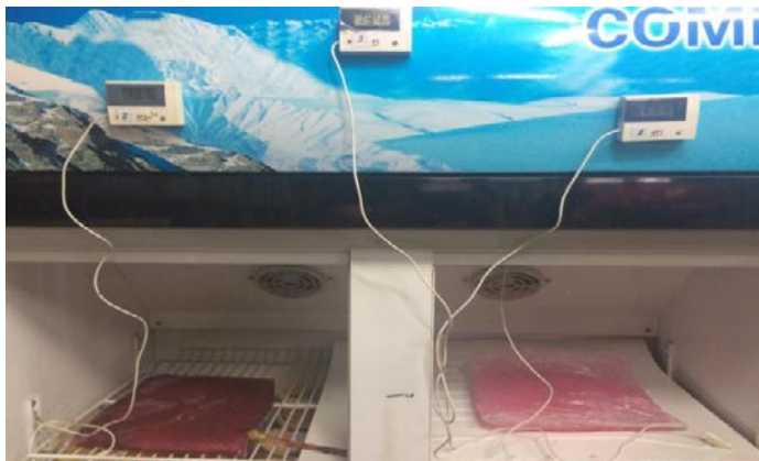
Зураг 4. Хөргөх камерт байрлуулсан усны хөлдөөлтийн байдал (1 цагийн дараа)
